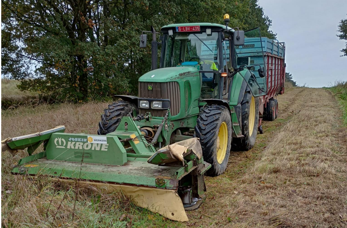
Foto 1: Tractor met frontmaaier en laadkar. Hierdoor is het mogelijk om een beheerovereenkomst te maaien met afvoer in één werkgang. @Werkers in Aanneming
